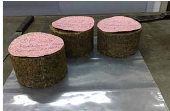
Figura 5.3 - Corpos de prova da mistura solo-emulsão (solo 1)
