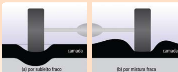
Figura 1 - Afundamento ou deformação permanente (FHWA, 1994)
