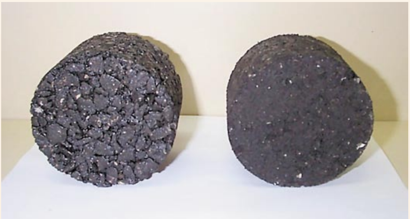
Figura 1 – Corpos-de-prova moldados de acordo com o Método Marshall.
