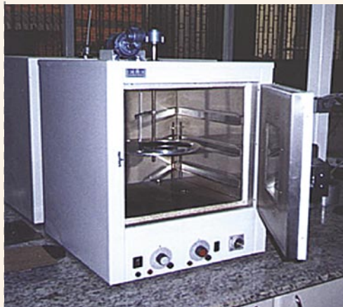
Equipamento para o ensaio de efeito do calor e do ar em película delgada (TFOT).
