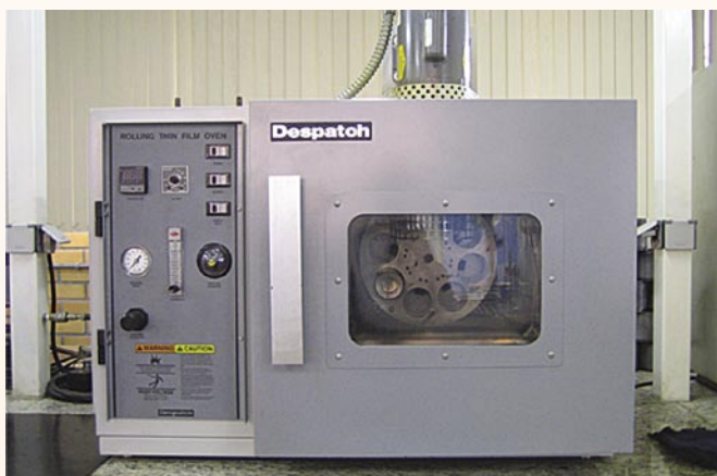
Equipamento utilizado para o ensaio de efeito do calor e do ar em película delgada rolada (RTFOT).
